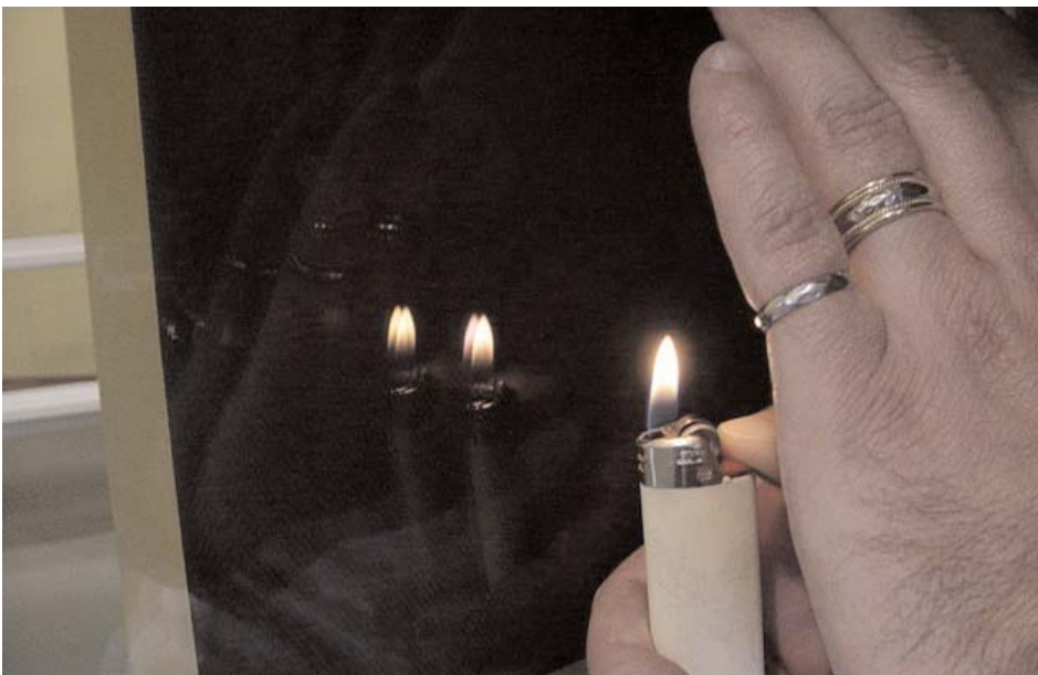
Figure 8 — Vue de l'intérieur, la réflexion indique qu'un revêtement à faible émissivité est présent sur la paroi n°3
