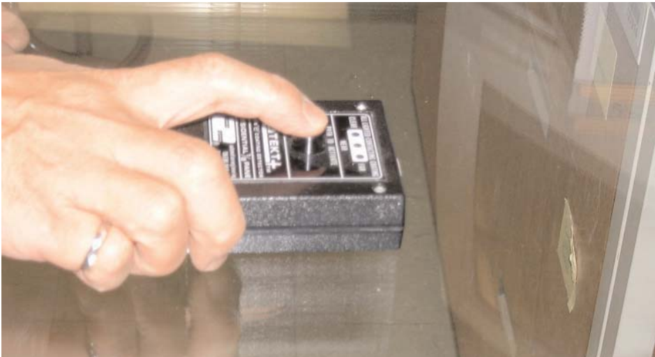
Figure 7 — Selon le voyant à DEL qui s'allume, l'utilisateur peut déterminer sur quelle paroi a été appliqué le revêtement à faible émissivité.
