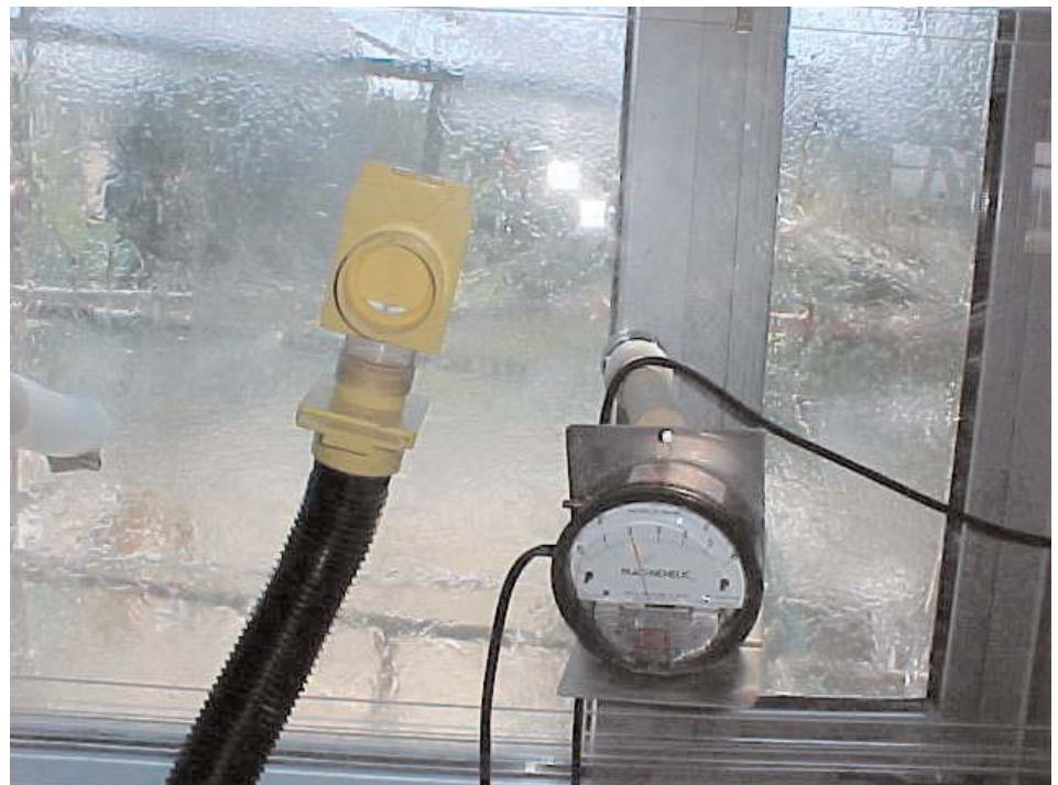
Figure 9 — Essai E1105 sur une fenêtre : la différence de pression est continuellement contrôlée à l'aide du manomètre à droite
